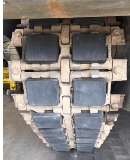
Ilustración 4. Cadena con zapatas nuevas. Elaboración propia.
