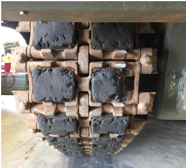
Ilustración 6. Zapatas desgastadas. Elaboración propia.
