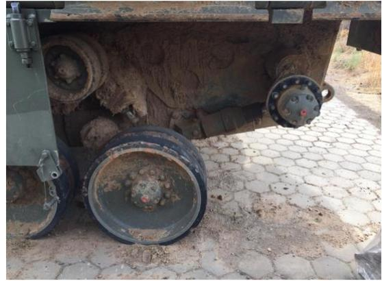
Ilustración 7. Acumulación de sedimento. Elaboración propia.
