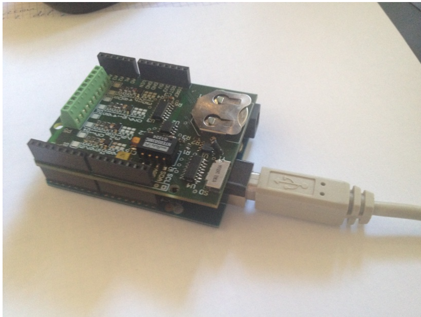
Figura 63: Placa Arduino y escudo S-LOGGER conectados al ordenador.
