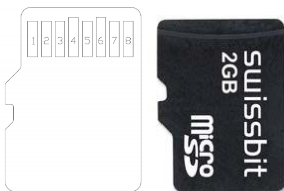
Figura 15: Patillaje y encapsulado de la tarjeta micro SD.
