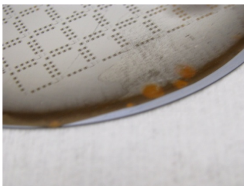
Ilustración 5.5: Detalle de una oblea estructurada a 200 W en el barrel etcher.
