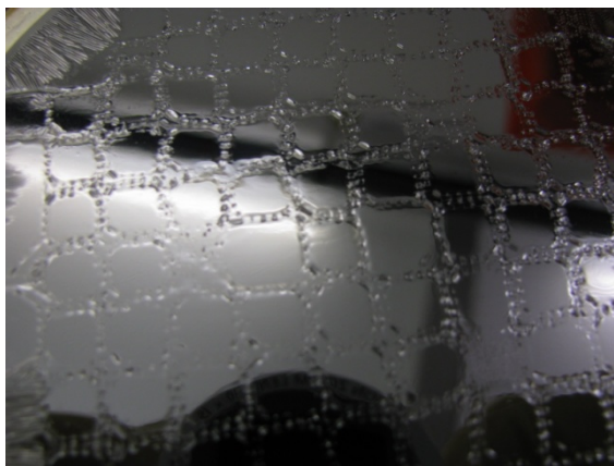
Ilustración 5.14: Olas y efectos no deseados en la primera oblea probada.
