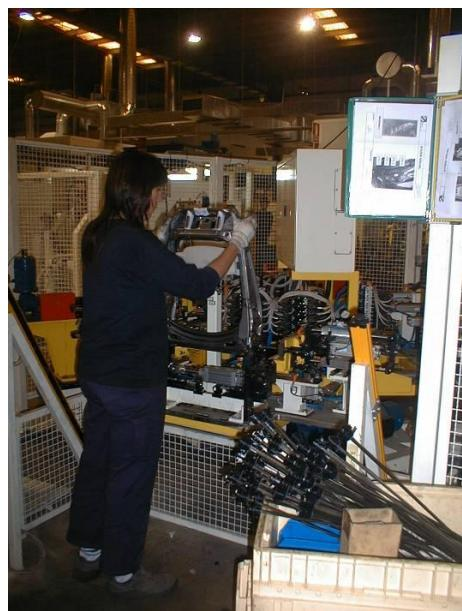
En estos procesos de fabricación la carga de componentes y soldadura automática de los diferentes componentes del armazón se realiza mediante máquinas automáticas. En algunos casos, como el montaje de los diferentes componentes internos del respaldo y el control del par de giro, se realizan en un proceso semiautomático.
