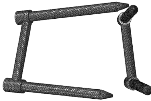
Figura 29. Geometría y malla del implante de titanio que conforma la fijación por tornillos utilizada para simular la cirugía artrodésica.
