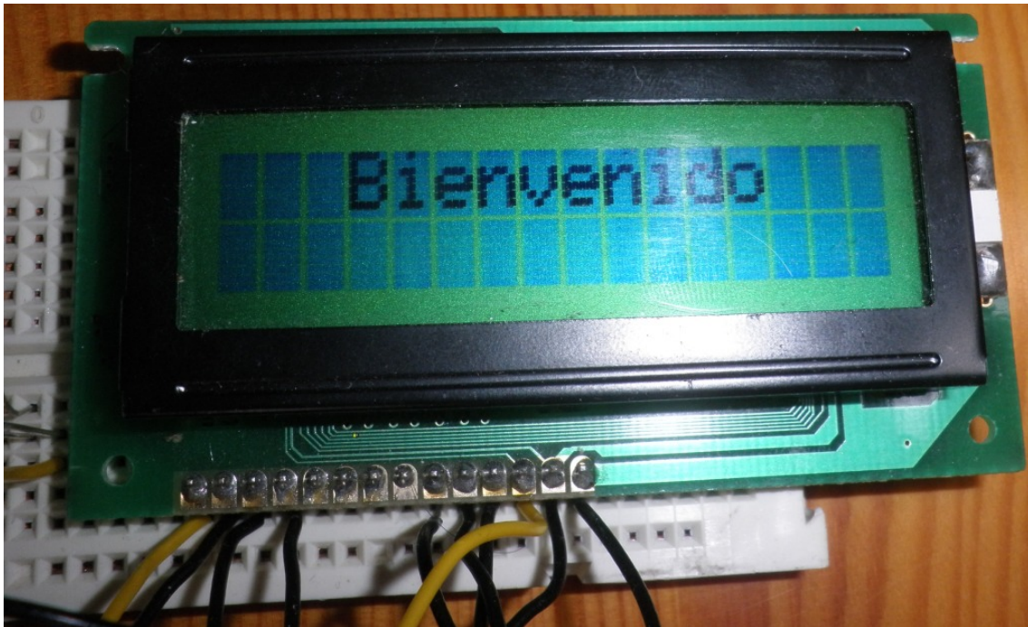
Ilustración 37. Verificación funcionamiento del display
