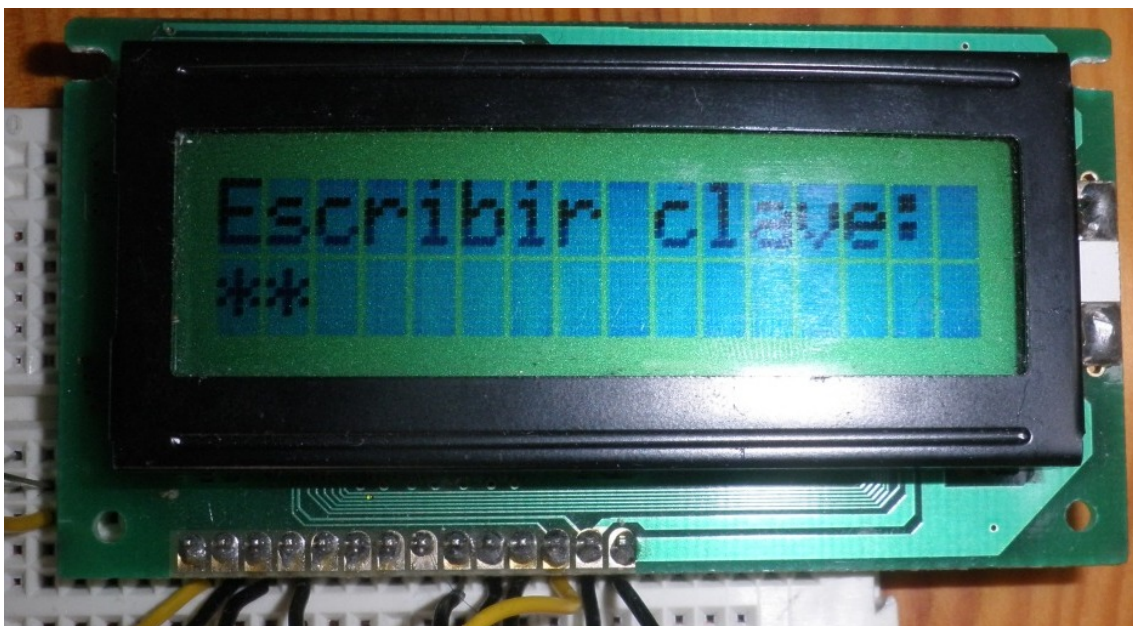
Ilustración 38. Verificación funcionamiento del teclado
