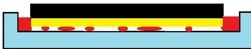
Figura 3.2.-Efecto de la capilaridad entre capas.
