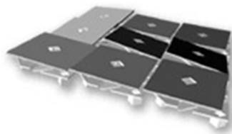
Figura 2.6.- Detalle de los cristales de un chip DMD.
