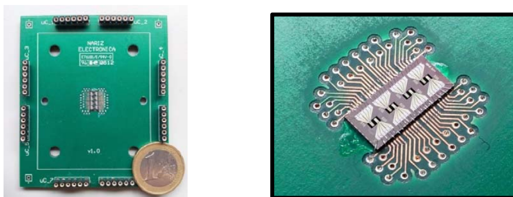
Imagen 3: Chip montado sobre una PCB con conexiones para los prototipos.
