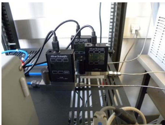
Imágenes 10 y 11: Controladores de flujo para determinar los caudales de nitrógeno (izquierda) y baños con los borboteadores contenedores de los analitos, llaves de corte y tuberías con calefacción (derecha).
