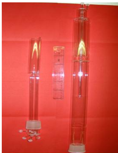
Figura B.17- Fotografía del reactor de flujo pistón de la instalación de fase gas a presión atmosférica.
