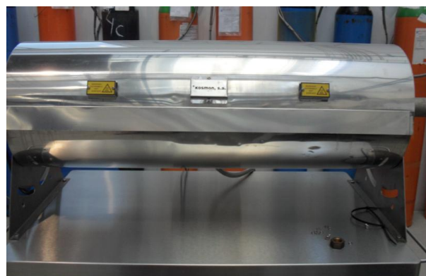
Figura B.27- Fotografía del horno eléctrico de la instalación de fase gas a presión.
