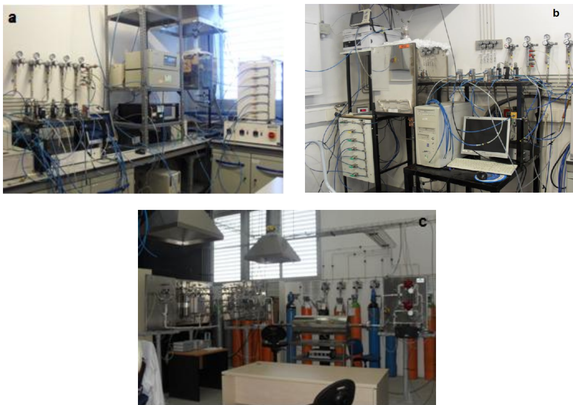
Figura B.1- Fotografía de las instalaciones experimentales utilizadas. (a) Instalación de fase gas a presión atmosférica. (b) Instalación de formación de hollín. (c) Instalación de fase gas a presión.
