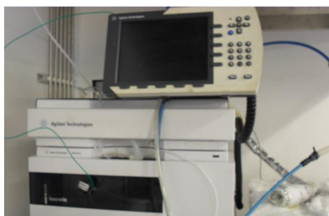
Figura B.3- Fotografía de la bomba HPLC isocrática de la instalación de formación de hollín.
