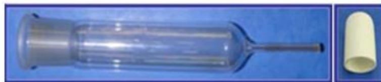
Figura B.24- Fotografía del sistema de recogida de hollín de la instalación de formación de hollín. Izquierda: Portafiltros. Derecha: Filtro.
