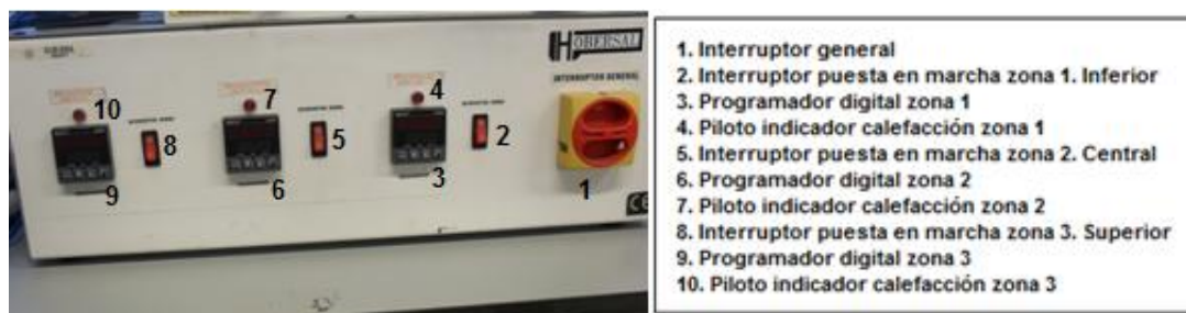
Figura B.20- Fotografía del sistema de control de temperatura del horno de la instalación de fase gas a presión atmosférica.
