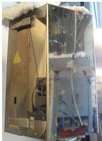
Figura B.19- Fotografía del horno eléctrico de la instalación de fase gas a presión atmosférica.
