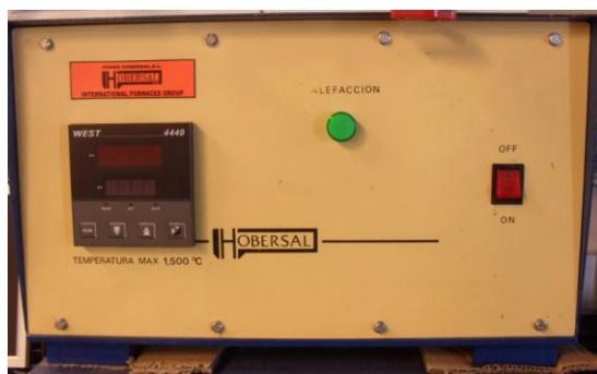
Figura B.23- Fotografía del sistema de control de temperatura del horno de la instalación de formación de hollín.
