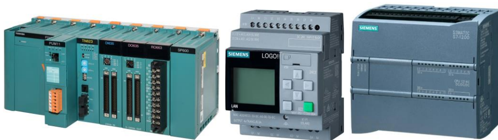
Fig. 64 Ejemplos de controladores lógicos programables
