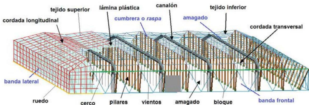
Fig. 33 Invernadero tipo raspa y amagado[36]
