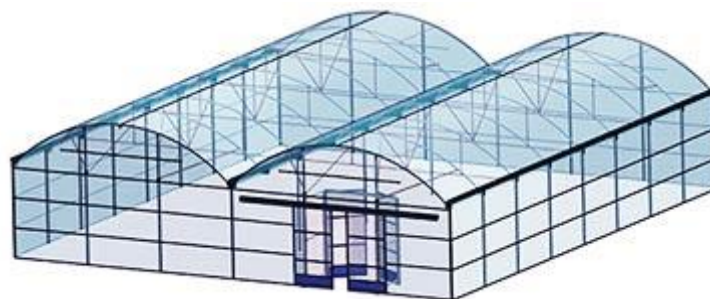
Fig. 37 Invernadero de doble capilla[39]
