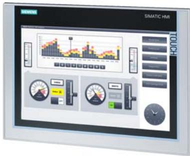
SIMATIC HMI TP1200 Comfort, Comfort Panel, mando táctil, pantalla panorámica TFT 12", 16 millones de colores, interfaz PROFINET, interfaz MPI/PROFIBUS DP, memoria de configuración de 12 MB, Windows CE 6.0, configurable a partir de WinCC Comfort V11
