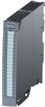
SIMATIC S7-1500 módulo de entradas/salidas digitales, DI16x 24VDC BA, 16 canales en grupos de 16, retardo a la entrada típ. 3,2 ms tipo de entrada 3 (IEC 61131), DQ16XDC 24V/0,5A BA; 16 canales en grupos de 8; 4 A por grupo; el módulo admite la desconexión de seguridad de grupos de carga hasta SIL 2 según EN IEC 62061:2021 y Cat. 2/PL c según EN ISO 13849-1:2015 el suministro incluye conector frontal de inserción rápida
