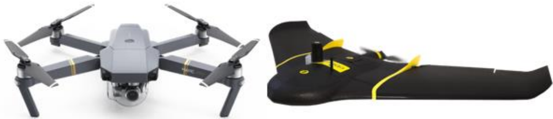
Figura 4: imagen de los dispositivos UAV empleados en el estudio. A la izquierda, el UAV multirrotor DJI Mavic-Pro2 y a la derecha el Sense Fly de ala fija eBee X. Fuente: elaboración propia.
