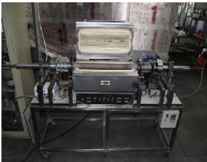
Figura 6. Reactor rotatorio empleado para la producción de NFC.
