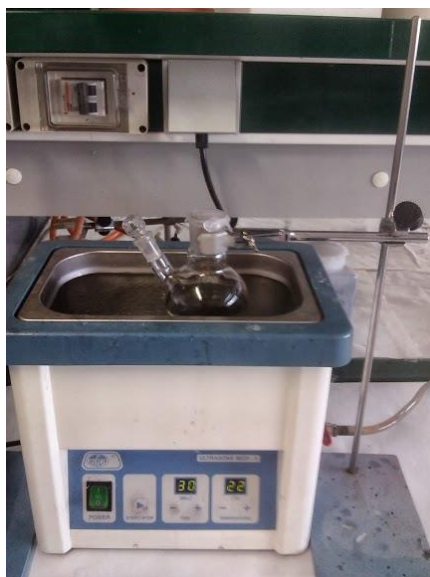
Figura 8. Ultrasonidos empleado para la precipitación y disolución del TMA
