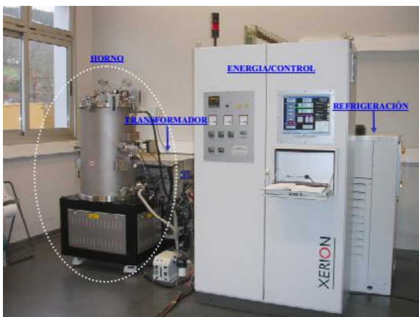
Figura 42. Fotografía del horno eléctrico de grafitización en CSIC, Oviedo
