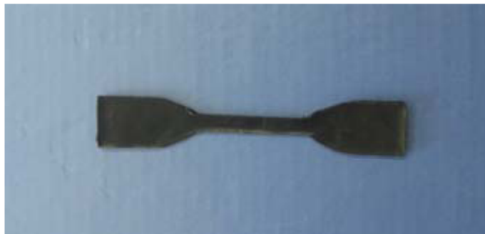
Figura 8. Probeta termoconformada de PEUAPM/MWNTs (1%).
