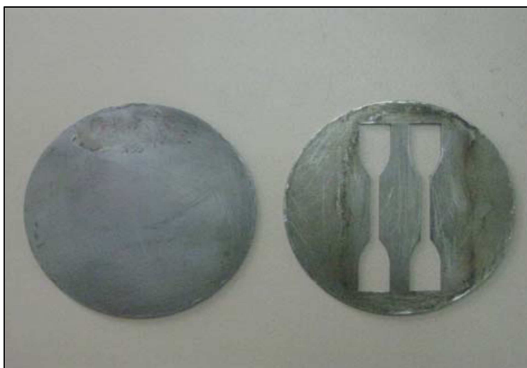
Figura 7. Molde utilizado para la obtención de probetas en el proceso de termoconformado.
