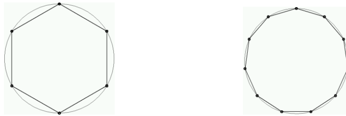
Fig. 1. El polígono de la derecha, al tener más lados, representa con mayor exactitud a la circunferencia.
