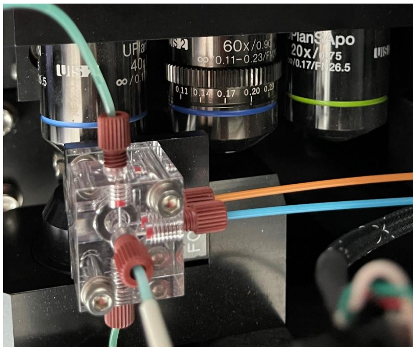
Figura 24. De izquierda a derecha, detalle de los objetivos de las ópticas de 40x, 60x y 20x integrados en el citómetro de imagen AMNIS®, ImageStream X del SAI Citómica (Fotografía del autor).
