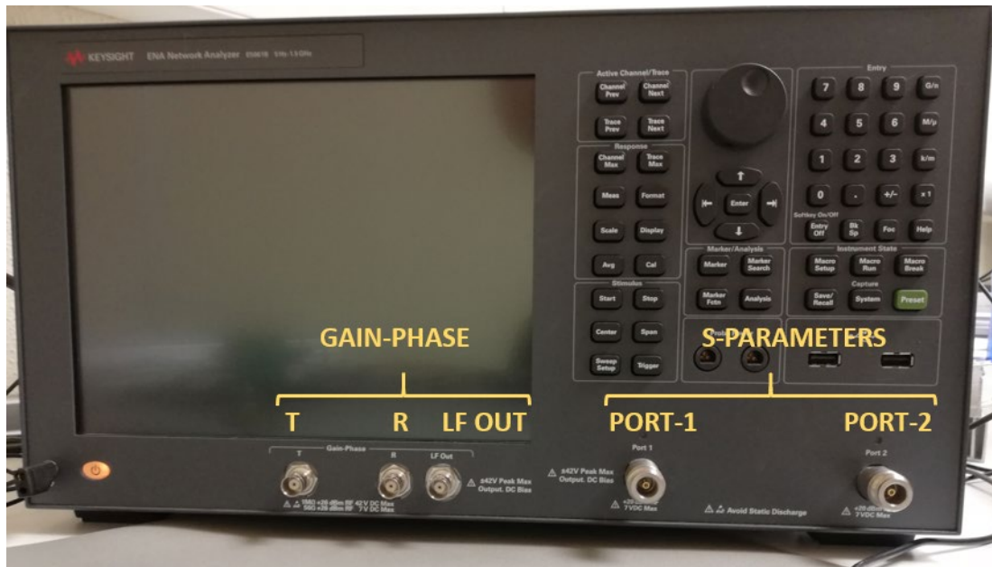
Fig. 3.10. Puertos de medida del analizador vectorial E5061B..
