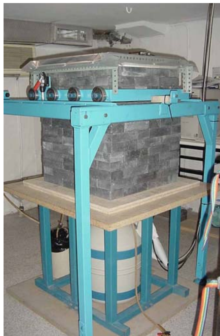
Fotografía III.3: Detector de germanio con blindajes activo y pasivo.
