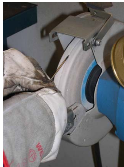
Fotografía VIII.4: Ensayo de afilado de las varillas de tungsteno toriado de 2,4 mm. de diámetro. Detalle de la piedra en el momento del afilado.
