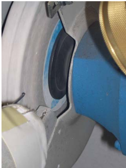
Fotografía VIII.4: Ensayo de afilado de las varillas de tungsteno toriado de 2,4 mm. de diámetro. Detalle de la piedra en el momento del afilado.
