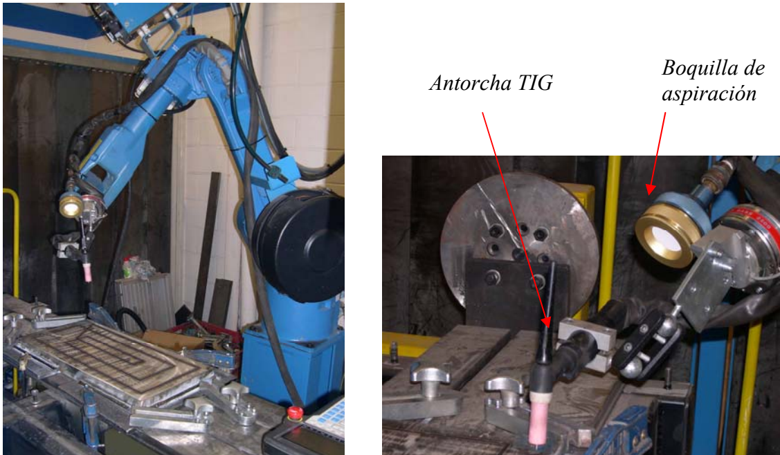
Fotografía VIII.1: Ensayo de soldadura con el robot automático. Detalle de la colocación del captador.
