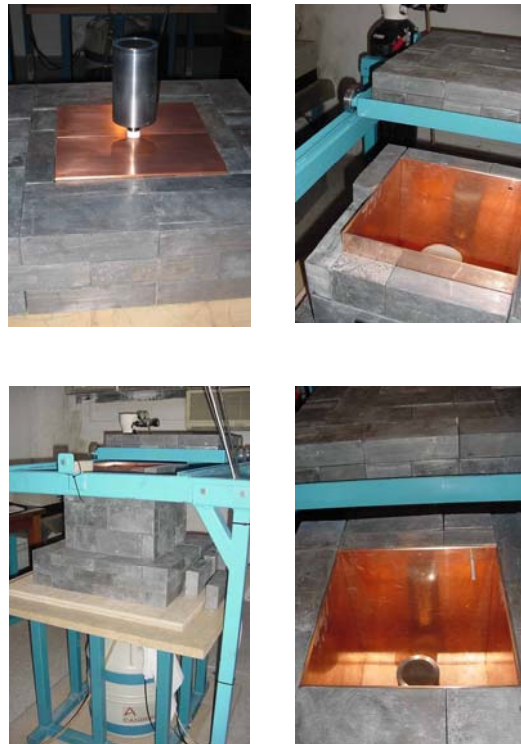
Fotografías III.1: Blindaje del detector de germanio con ladrillos de plomo y caja de cobre.
