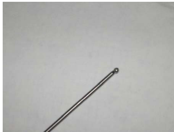
Fotografía VIII.3: Extremo de la varilla de tungsteno toriado de 2,4 mm. de diámetro después de su utilización en soldadura manual.
