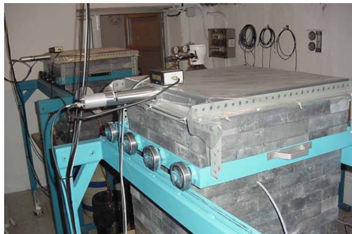
Fotografía III.2: Detector de germanio con blindaje de plomo y veto cósmico.
