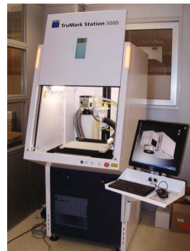
Figura 3.2. Equipo láser TruMark Station 5020
