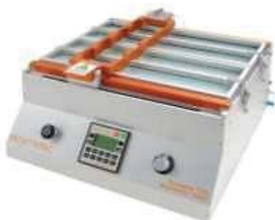
Figura 3.12 Abrasímetro lineal utilizado
