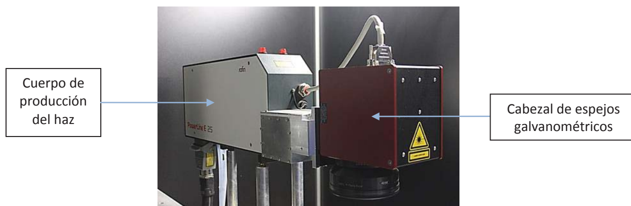
Figura 3.5. Partes diferenciadas de la óptica de un equipo láser
