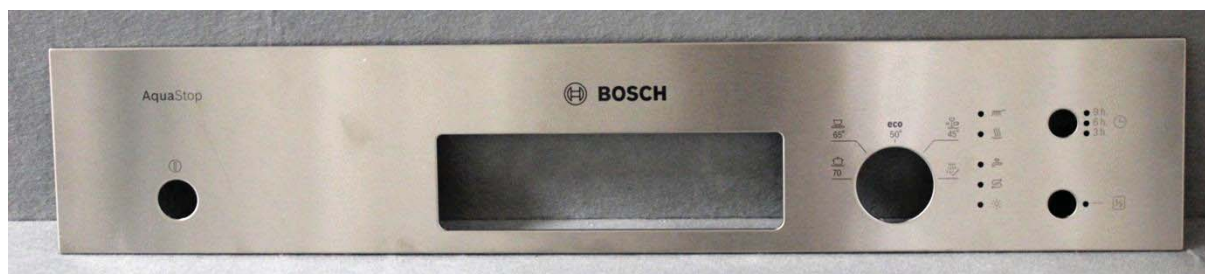
Figura 4.1. Frontal de lavavajillas marcado con parámetro 225.600.60.2 con el equipo TruMark 5020
