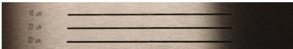
Figura 3.7. Errores de 10, 20 y 30 micras detectables por el ojo humano.
