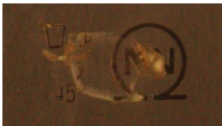
Figura 4.3. Ejemplo de marca afectada por picaduras tras test de gota salada
