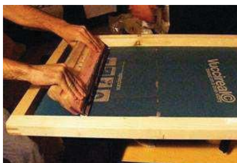
Figura D.11 Aplicación de la rasqueta en la impresión por tampografía
