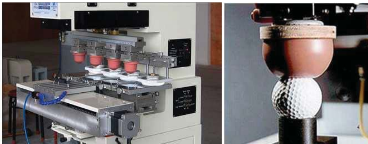
Figura D.1 Máquina de tampografiado (izda.) y una almohadilla, elemento característico del proceso (dcha.)
