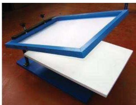
Figura D.6 Marco de serigrafía ensamblado al bastidor de la máquina
