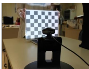
Figura 6.2 Etapa de calibración con la Webcam
