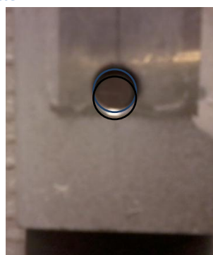
Figure 4.2. Défaut de positionnement
