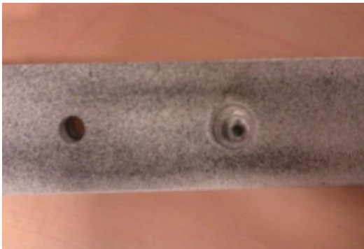
Figure 4.3.2. Mouchetis sur l'éprouvette
