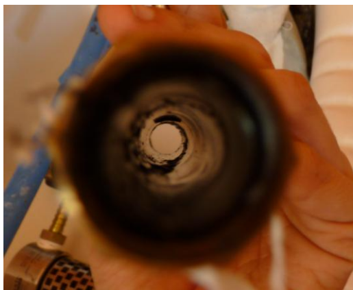
Figura 25. Imagen del interior de uno de los conductos de gases, donde se observan alquitranes pegados a las paredes
