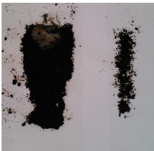
Figura 21. Sólidos extraídos del ciclón primario (izquierda) y secundario (derecha) tras un experimento con polietileno puro
