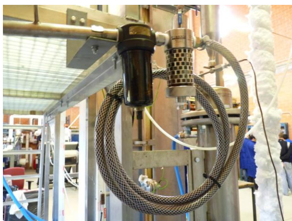
Figura 24. Imagen del sistema de captura de alquitranes tras un experimento
