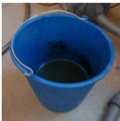
Figura 23. Líquidos recogidos del depósito de alquitranes en el condensador tras un experimento
