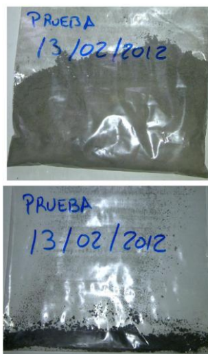
Figura 22. Sólidos extraídos del ciclón primario (arriba) y secundario (abajo) tras un experimento con residuo film
