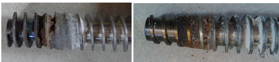
Figura 20. Imágenes del tornillo de alimentación tras dos experimentos diferentes, donde se aprecia la aglomeración de plástico cerca del extremo
