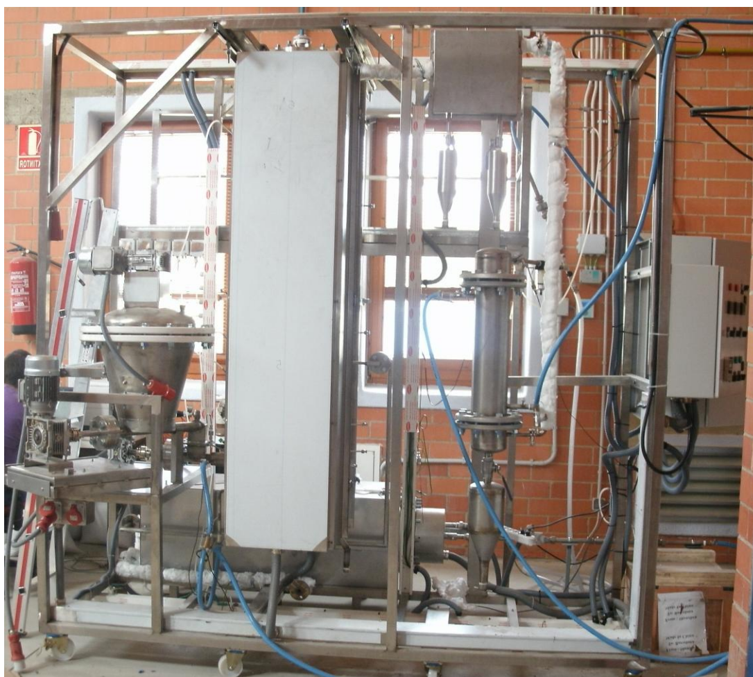
Figura 6. Imagen de la instalación experimental de gasificación de plásticos en CIRCE
