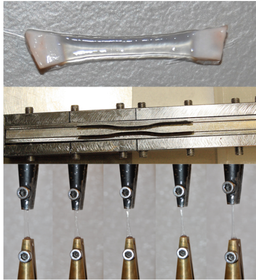
Figura 7. Test de tracción uniaxial in vitro . Sección de la probeta y aplicación de ciclos de tracción-relajación hasta alcanzar deformaciones del 3, 6, 12% de la longitud inicial y la posterior rotura de la misma.
