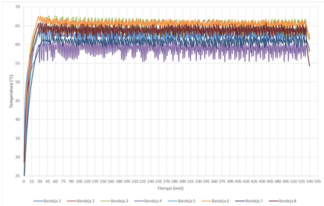
Gráfica 4.3. Perfiles de temperatura de cada posición en el interior del deshidratador a 65°C
