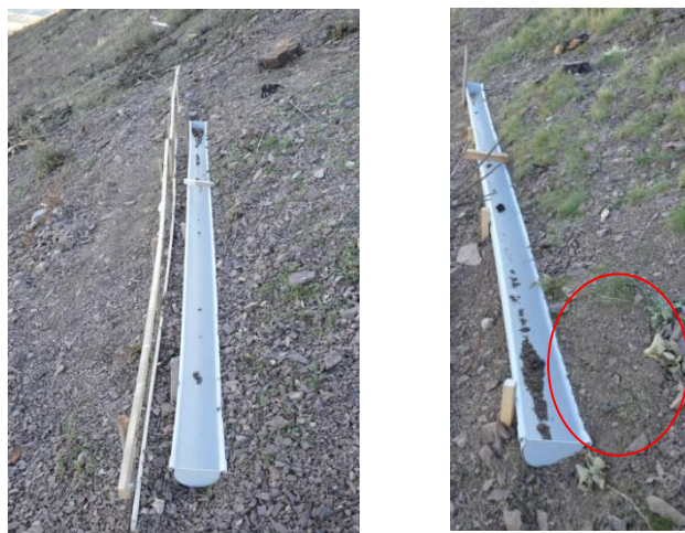
Figura 72. Izquierda: ejemplo de trampa de sedimentos, funcionamiento de procesos erosivos junto a la propia trampa. Figura 73. Parcela PCI (2). Sector con presencia de materiales finos.
