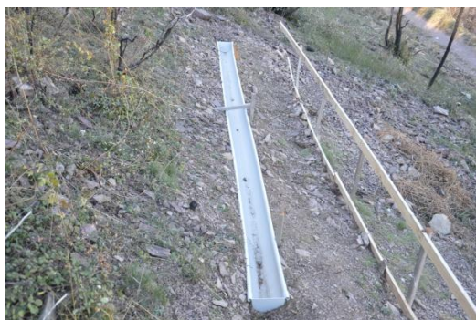
Figura 15. Trampa de sedimentos construida con un canalón de PVC.
