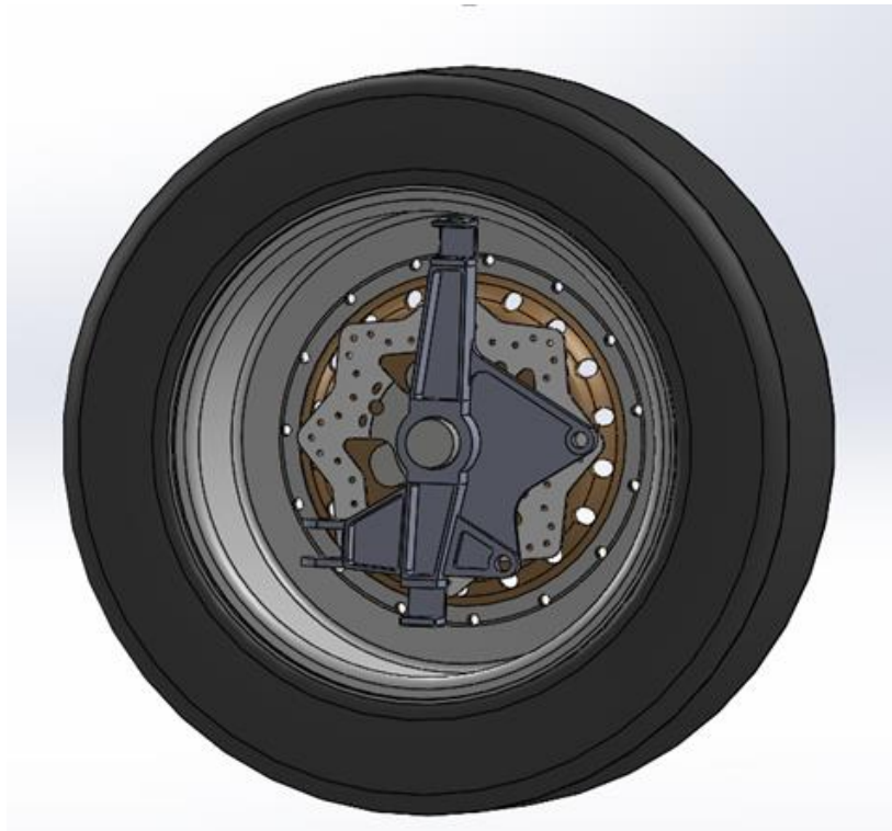
Ilustración 40 Ensamblaje de la rueda mediante SolidWorks
