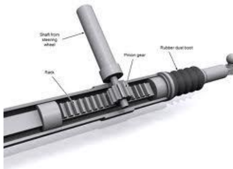
Ilustración 5 Caja de dirección (cremallera-Piñón)
