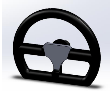
Ilustración 26 Diseño de Volante mediante SolidWorks
