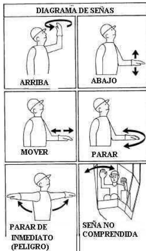
Las señas con la mano a los operadores de grúas deben ser claras y precisas, ajustándose a un código o sistema reconocido.
