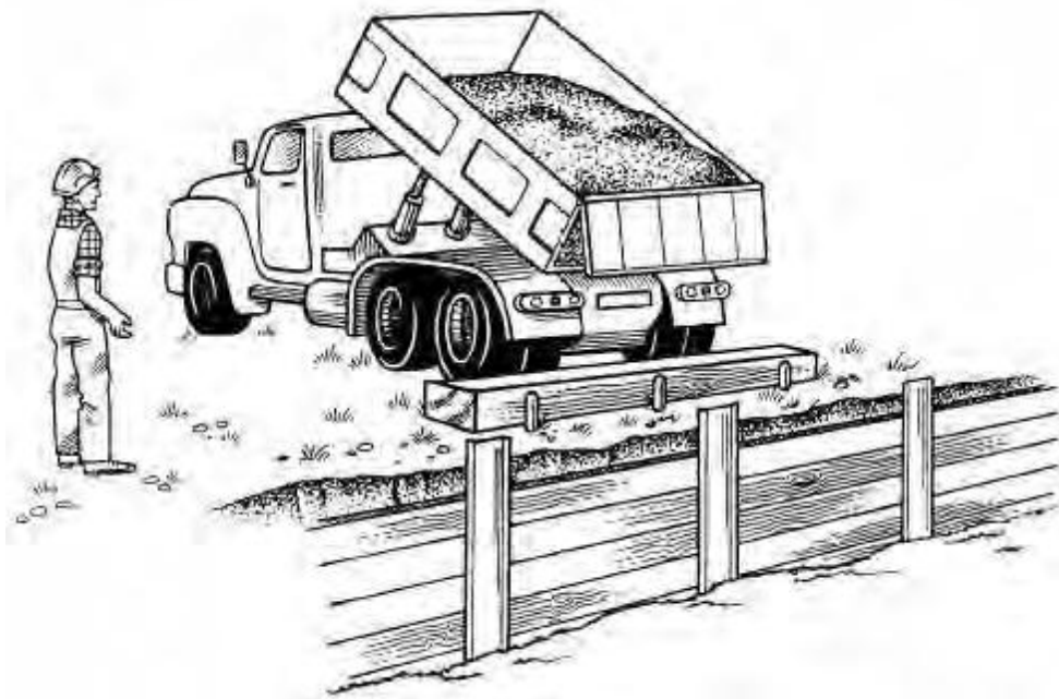
Bloques de tope para impedir que los camiones volquetes se deslicen dentro de la excavación al descargar en marcha atrás.
