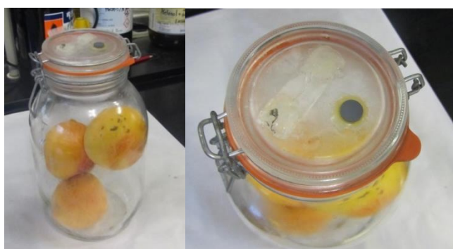
Fig. 10. Botes cerrados para medir la actividad respiratoria y la producción de etileno de los melocotones.
