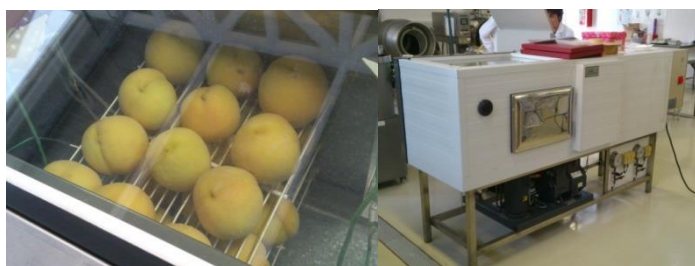
Fig.20. Túnel de congelación (izqda.) y melocotones dispuestos en su interior (dcha.)
