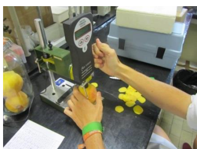
Fig. 9. Medida de la firmeza del Melocotón de Calanda con penetrómetro manual
