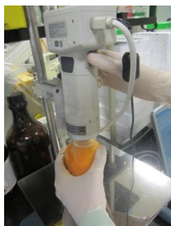
Fig. 8. Medida del color mediante colorímetro
