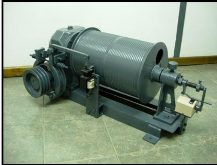
Figura 1.3. Máquina de tambor de arrollamiento. Ascensores GBA (Argentina)
