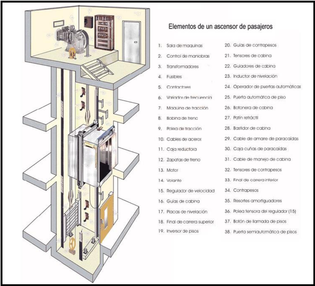
Figura 1.14. Partes de ascensor eléctrico.
