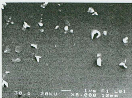
FIGURA 20: película LB con 15 capas transferidas a 30 mN/m de DPOPBr a 8000 aumentos con electrones secundarios
