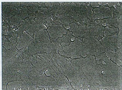
FIGURA 7. Fotografía SEM de una película de ácido behénico puro, registrada a 8000 aumentos, con electrones secundarios.
