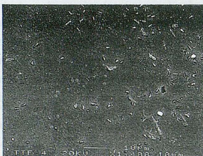
FIGURA 9. Fotografía SEM de una película de TTFH+BA 1:1, registrada a 1400 aumentos (electrones secundarios).
