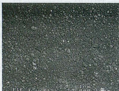
FIGURA 10. Fotografía SEM de una película de TTFH + BA 1:1, registrada a 8000 aumentos (electrones secundarios).
