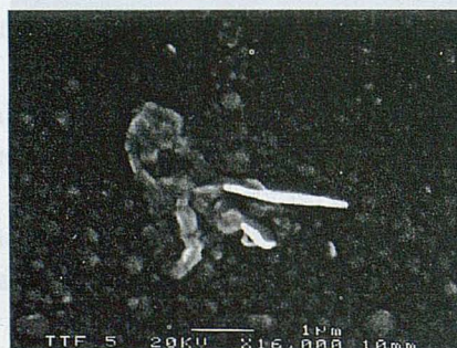
FIGURA 11. Fotografía SEM de una película de TTFH+BA 1:1, registrada a 16000 aumentos (electrones secundarios) donde podemos ver con detalle una de las líneas brillantes observadas en la figura 9.
