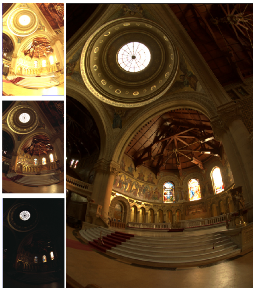
Figura 1.1: Se puede obtener una imagen HDR a partir de capturas de la misma escena con distintos valores de exposición.
