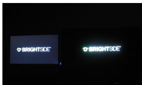
Figura B.11: Las diferencias entre el monitor HDR (derecha) y el LDR (izquierda) son muy notables: el blanco es más brillante, y el negro es más oscuro en el HDR. En el LDR se aprecian las consecuencias de la limitación de rango.
