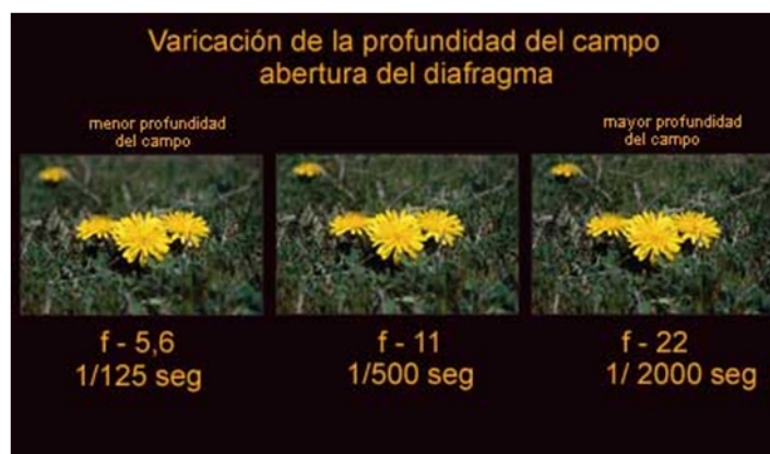
Figura A.5: Variación de la profundidad de campo con la apertura del diafragma
