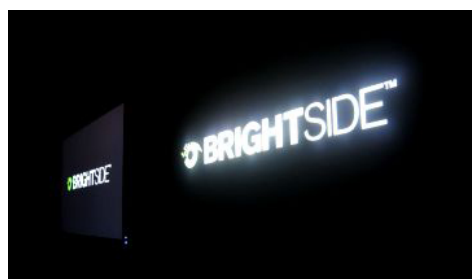
Figura B.12: Las diferencias entre el monitor HDR (derecha) y el LDR (izquierda) se aprecian también al observarlos desde un lado.
