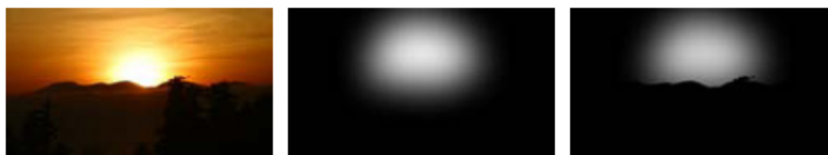
Figura 4.6: Aumentando el rango dinámico de las imágenes. La fotografía de la derecha es de la que quiere aumentarse el rango. La figura del centro muestra el resultado de ejecutar la función de aumento de brillo, y en la derecha se incorpora la edge stopping function , que previene que se aumente el rango en bordes marcados [RTS + 07].
