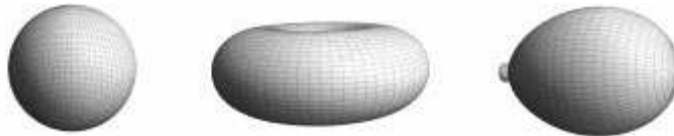
Figura. A.12.- Diagramas de radiación en 3D, isótropo, omnidireccional y directivo
