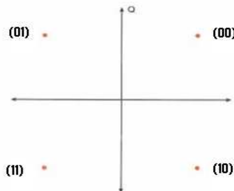
Figura.A.20- Constelación de símbolos de la modulación \pi/4 DPSK
