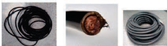
Figura 14. Cable de sección 50 \text{mm}^2 y tubo de poliamida
