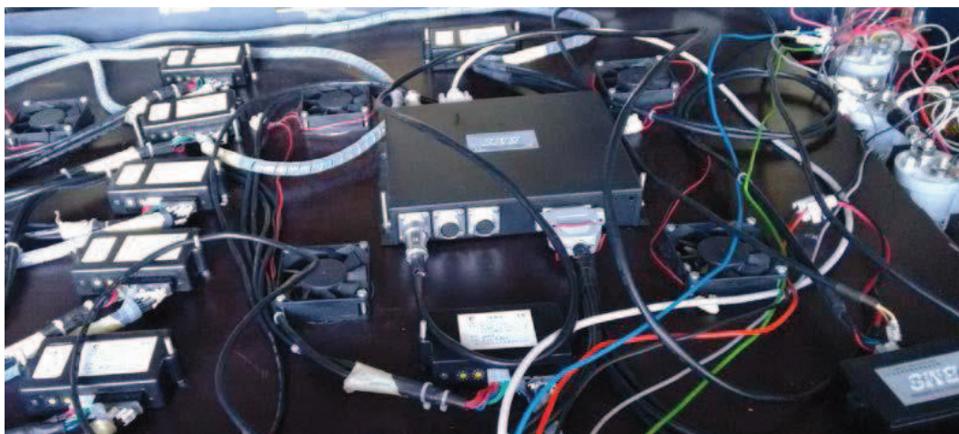
Figura 62. Distribución de módulos en el cajón principal de baterías
