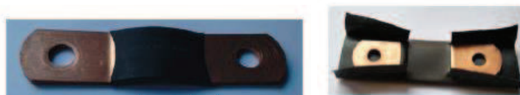
Figura 12. Pletina de cobre y su doble protección de aislamiento
