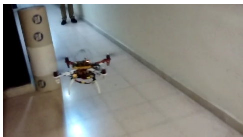
(c) Detección del segundo obstáculo y corrección de la orientación
