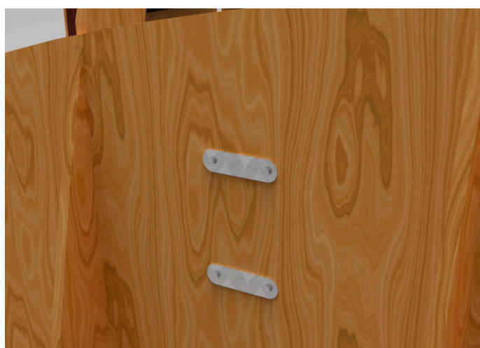
Fig. 92- Secciones unidas con chapas y pasadores.
