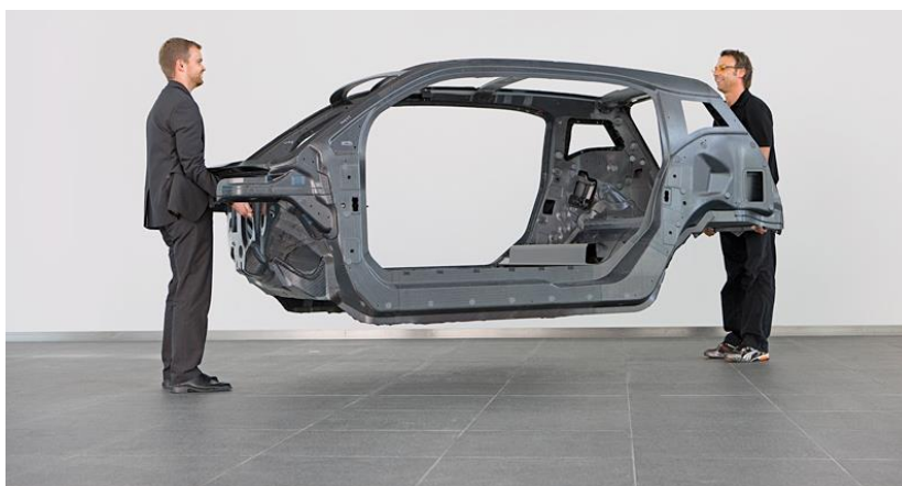
Figura 6. Chasis monocasco de CFRP (Plástico reforzado de fibra de carbono) del BMW i3. Fuente: BMW
