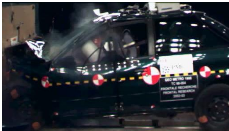
Figura 44. Ensayo de choque frontal del Geo Metro 3 puertas de 1998 contra una barrera fija a 56,16Km/h [18]
