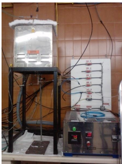
Figura 3. Instalación experimental utilizada en el estudio de interacción hollín-NO.
