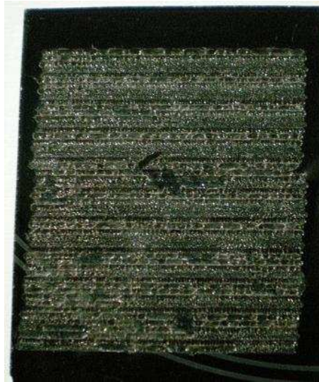
Figura 17. Cristal vitrocerámico agrietado.
