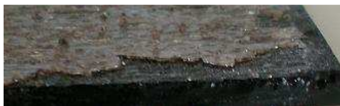
Figura 14. Muestra de 8% de óxido de boro y 92% de polvo vitrocerámico
