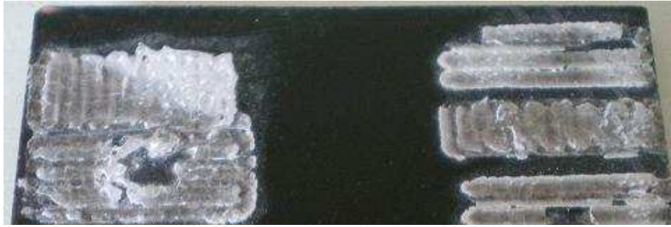
Figura 11. Muestra con tratamiento superficial realizado con el software del laser de CO 2 .
