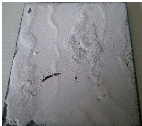
Figura 4. Muestra con numerosos cristales vitrocerámicos sobre la superficie.
