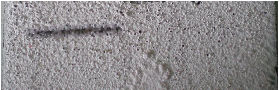
Figura 10. Muestra tratada con horno tras la deposición. Se observan burbujas en la superficie.
