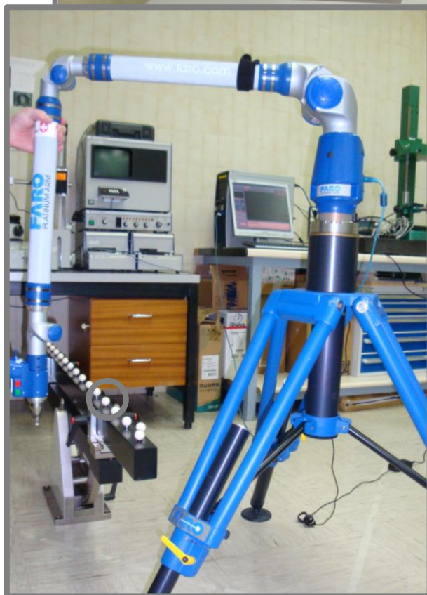
Posición 2 de la esfera patrón en la prueba de error de palpado.
