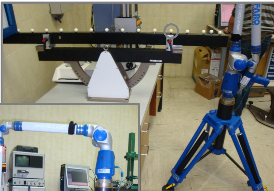
Posición 1 de la esfera patrón en la prueba de error de palpado.
