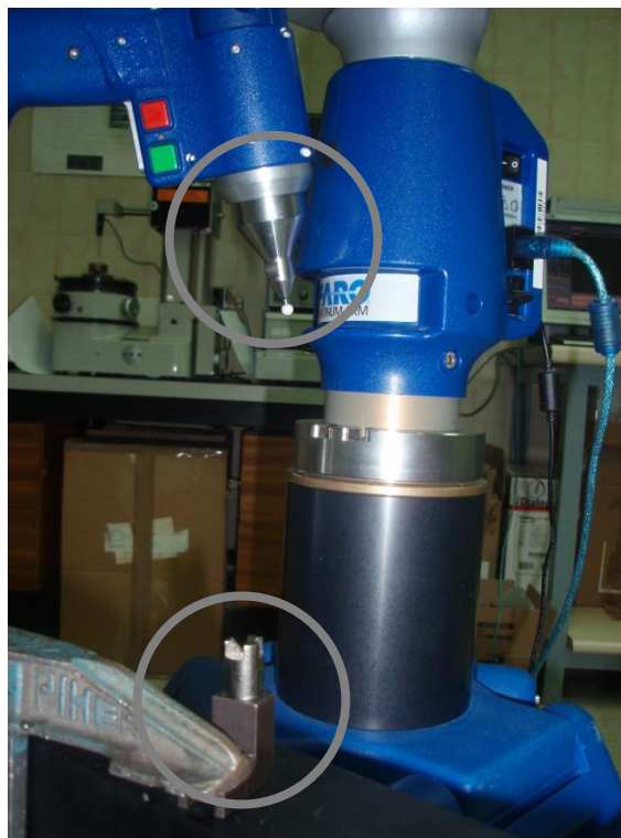
Detalle de palpador y asiento cinemático empleados.
