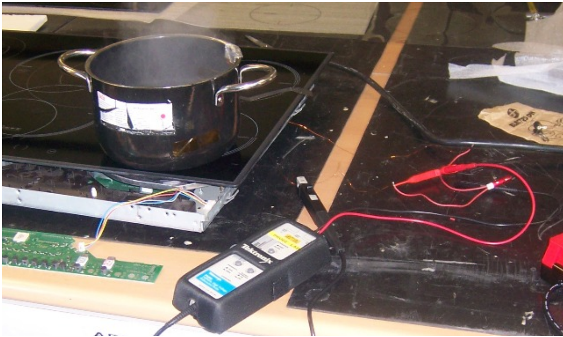
Figura 48: Valoración de potencia capturada alrededor de la bobina de la placa
