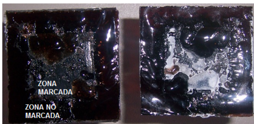
Figura 28: Muestra 5, se observa la zona cuadrada marcada con láser
