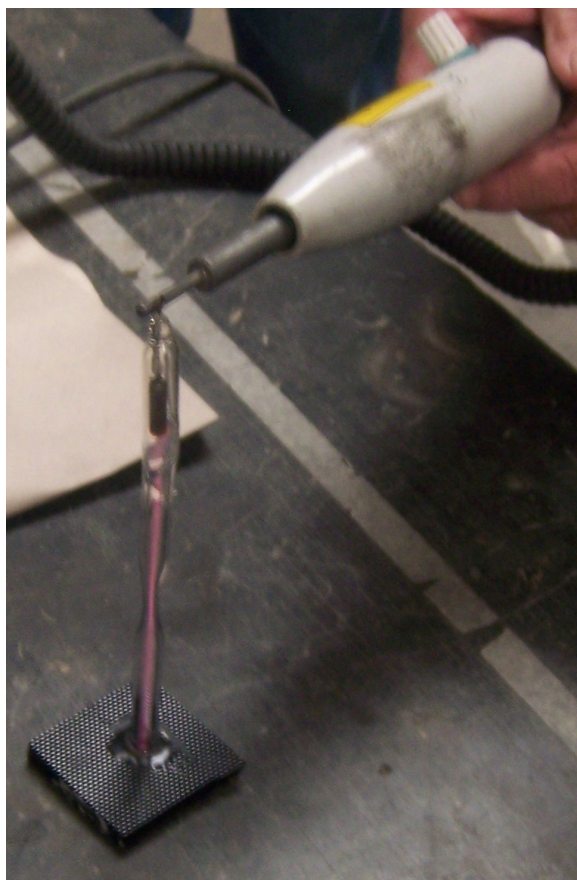
Figura 51: Luz en pieza final obtenida con chispómetro
