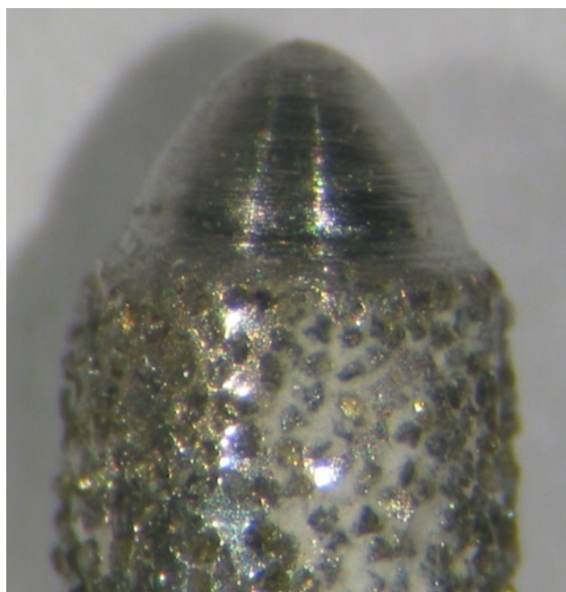
Figura 16: Detalle de la muela de diamante desgastada
