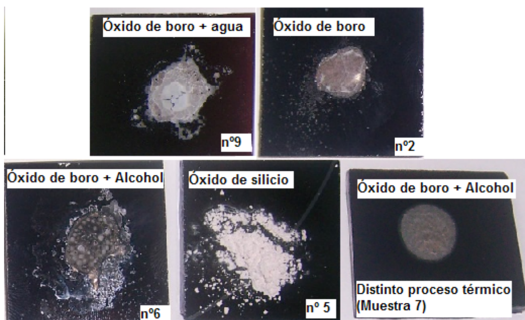
Figura 26: Muestras de estudio individual de los componentes de la mezcla A, se indica el número de muestra y el disolvente en el caso de que se utilice
