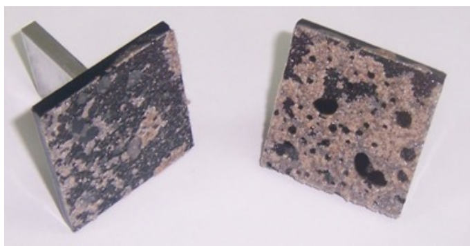
Figura 20: Muestra con fundente n°14 , a la izquierda aparece la placa situada superiormente durante la tracción
