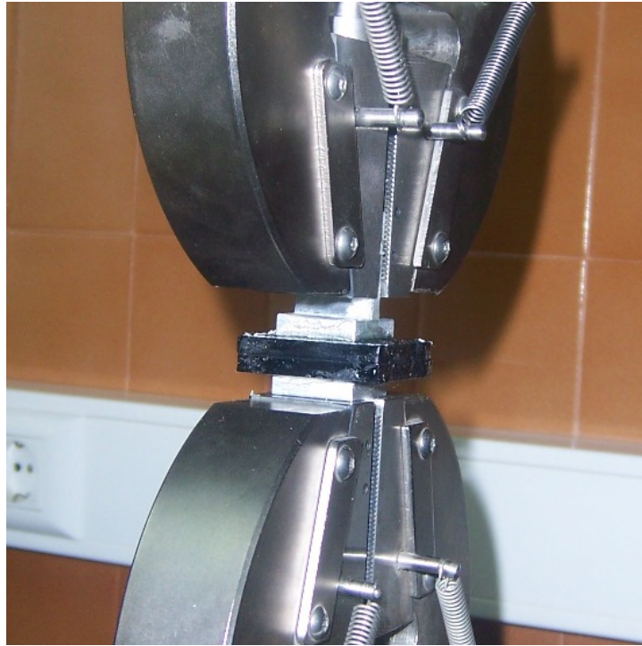
Figura 86: Muestra preparada para tracción, las mordazas sujetan firmemente las T de aluminio
