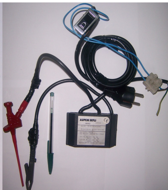
Figura 101: Electrodo y electrodos unidos para crear lámparas de pequeño tamaño, junto al transformador utilizado para encenderlas
