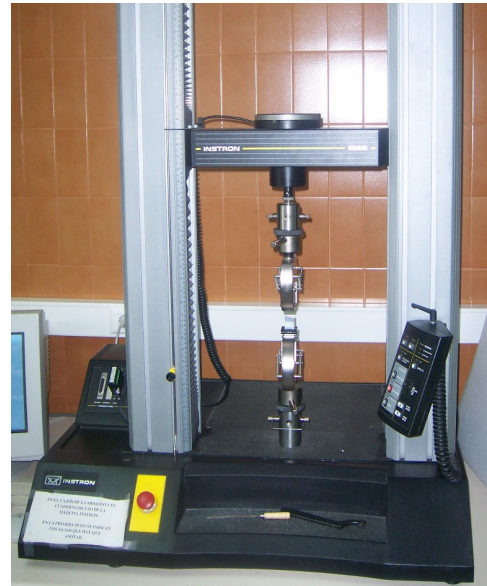
Figura 82: Máquina de tracción esquema y foto (máquina Instron)
