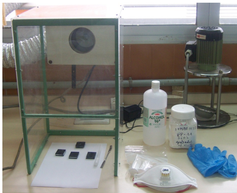
Figura 98: Campana extractora, etanol, mascarilla, guantes y pipeta para usar fundente y óxidos
