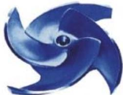
**Semi-abierto:** se construye sobre un plano colocado en el lado opuesto de la entrada del líquido. Esta construcción refuerza las paletas disminuye la presión sobre la parte posterior del impulsor y lo protege de la entrada de materiales extraños.
