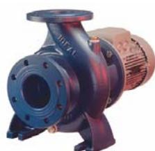
**Eje libre:** el eje de la bomba esta sin conectar a ningún motor, permite la unión al motor que la hace girar como el cliente lo desee realizar. Ha de disponer de una bancada como soporte común a la bomba y al motor. La alineación de los ejes es fundamental para prevenir posibles averías.
