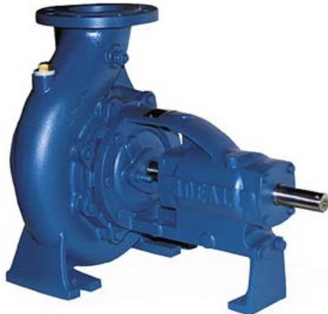
Impulsor: fundido en Bronce o acero inoxidable de tipo cerrado. El sentido de giro es el horario (a derechas) situándose del lado del acoplamiento. Dicho impulsor estará montado sobre un eje en voladizo. Se debe elegir el impulsor con el diámetro adecuado para optimizar el rendimiento de la bomba al punto de trabajo de pleno rendimiento.
