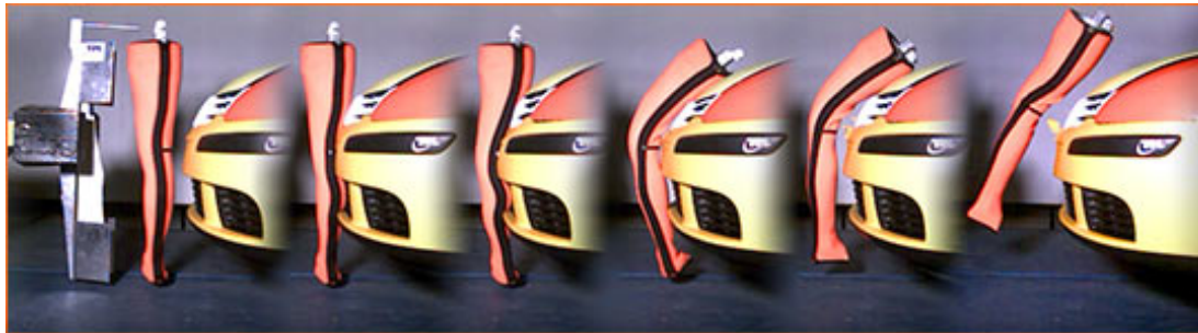
Figura 1: Choque de un Impactador TRL contra paragolpes
