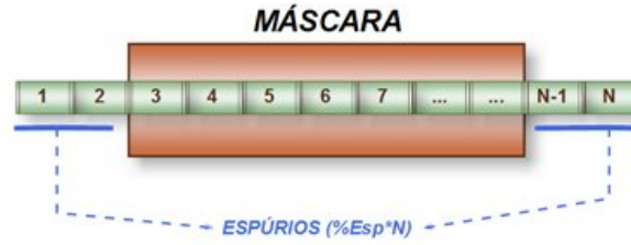
Figura 4.9: Filtro sobre la secuencia de índices. Está determinado por una máscara central sobre la secuencia. El número de índices que no son seleccionados sobre la secuencia viene determinado por N * \%Espuros , quedando en los extremos de la máscara la mitad de éstos.
