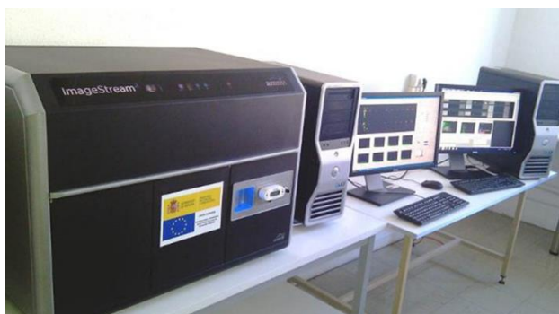
Citómetro de flujo AMNIS ImageStream X. Combina la captura microscópica de imágenes a alta velocidad con la citometría de flujo (citometría de imagen)
