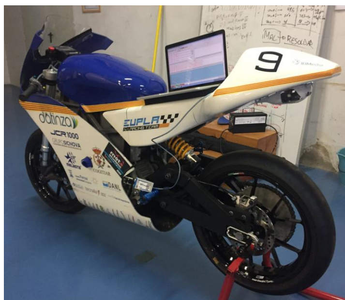
Ilustración 67: Imagen del vehículo conectado al terminal de parametrización
