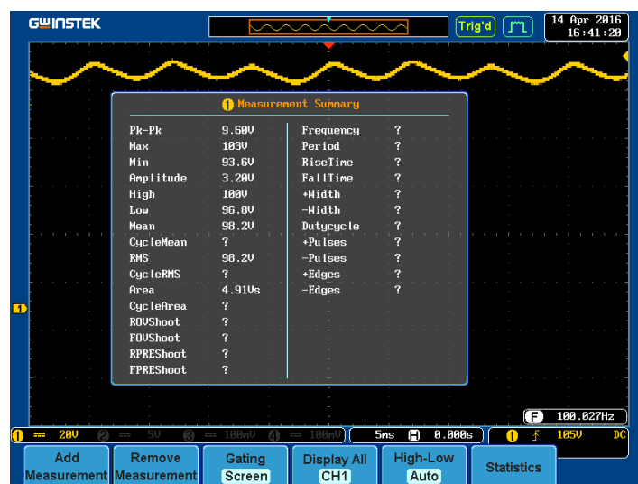
Ilustración 37: Captura de osciloscopio tomada en la salida de la fuente de alimentación
