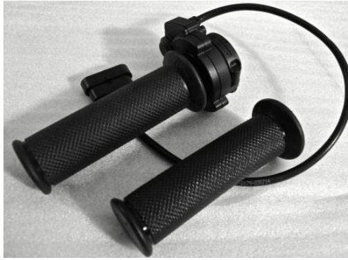
Ilustración 38: Potenciómetro 0-5KΩ de Domino
