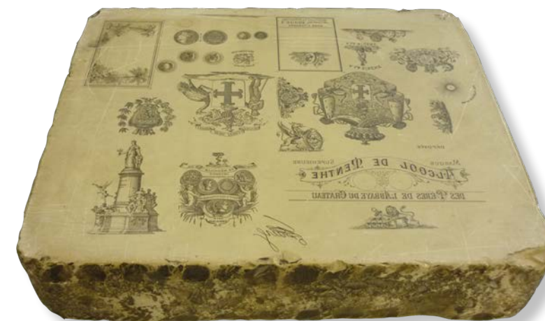
Piedra litográfica con dibujos de marcas y etiquetas. ◀
