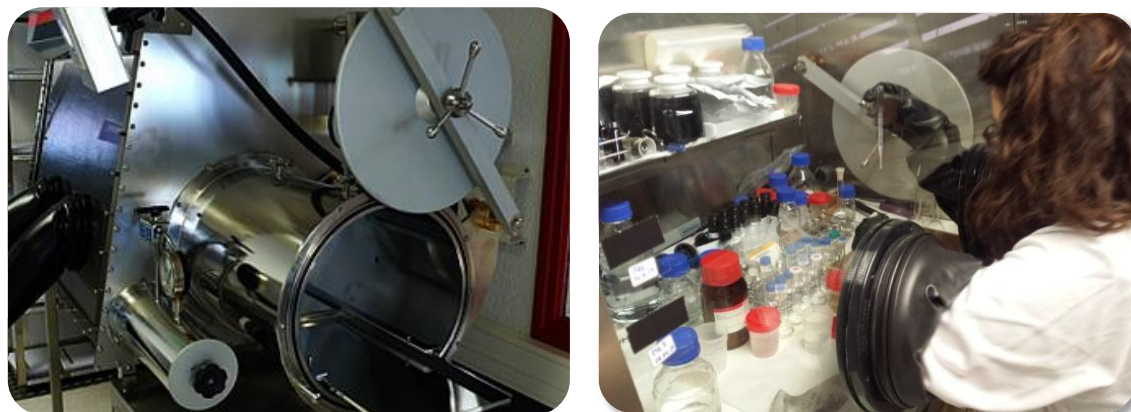
Fig 3. En la foto de la izquierda se muestra la cámara de guantes Jacomex empleada en el laboratorio. En la foto de la derecha se muestra el modo de operación con los guantes para la preparación de muestras.
