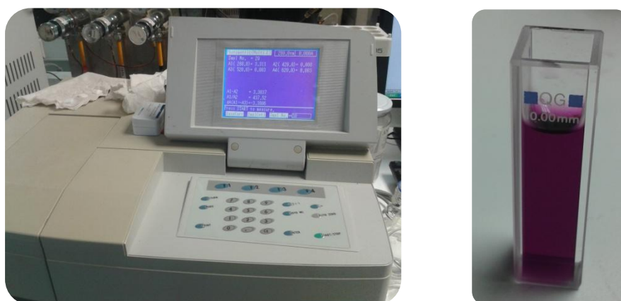
Fig 1. A la izquierda aparece el Espectrofotómetro Ultravioleta-Visible Shimadzu modelo UV-1700 empleado en el laboratorio. A la derecha una cubeta de cuarzo con la muestra de análisis.
