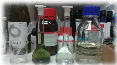
Fig 3. Parte del material necesario dentro de la cámara anóxica para la preparación de las disoluciones madres de \text{Cl}_2\text{Fe}\cdot 4\text{H}_2\text{O} y \text{Cl}_3\text{Fe}\cdot 6\text{H}_2\text{O} .
