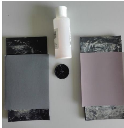
Figura II.3 Lijas utilizadas para el pulido de una fibra POF
